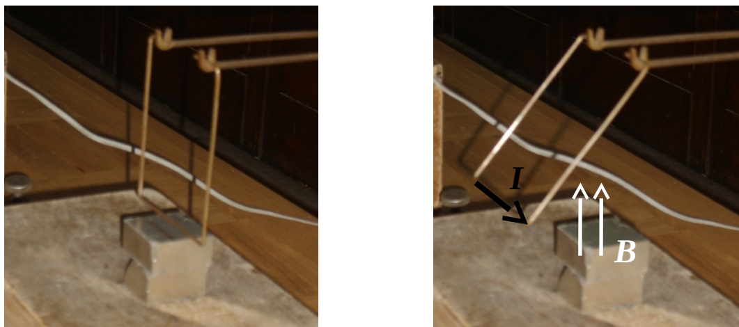
Rys. 4.3.2. Ramka zawieszona nad magnesem ( po lewej). Po przepuszczeniu przez ramkę prądu elektrycznego zaczyna na nią działać siła, która powoduje jej wychylenie (po prawej)
